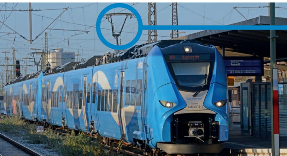
Über die Schleifleisten und den Stromabnehmer wird der Zug mit Strom versorgt
